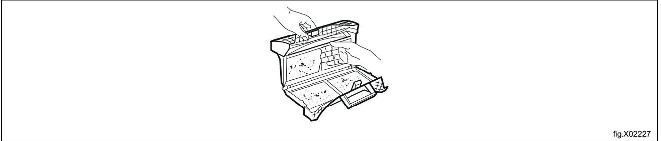
5. Bei Bedarf können Sie das Flusensieb mit einem Staubsauger reinigen. Schließen Sie das Flusensieb.
